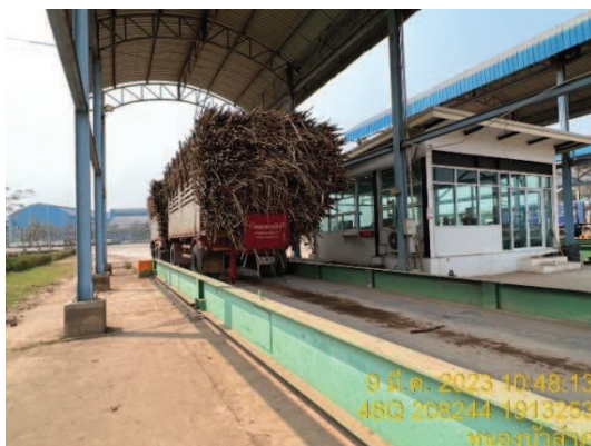
รูปที่ 27 เครื่องชั่งน้ำหนักรถบรรทุก
